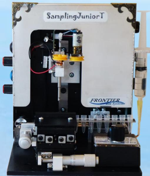
SamplingJuniorは病理切片を含む種々生体組織切片から極微小断片を簡便に採取するシステムです。オプションのデジタル顕微鏡或いは倒立顕微鏡に搭載し、顕微鏡画像を見ながら、採取部位を採取針が下りてくる位置に手動で移動し、ボタン一つで自動的に採取・回収します。採取にはステンレス製の中空採取針を用います。直径約0.12mmの微小切片を採取します。採取された切片は遺伝子発現、たんぱく質発現などの分析に使用され、それらが場所によってどのように変化していくかを調べることができます。
